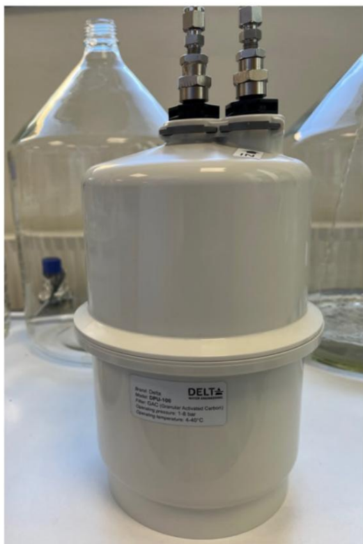
Delta DPU-100 vandfilter, tilsluttet fødevand med tilsatte uønskede stoffer
